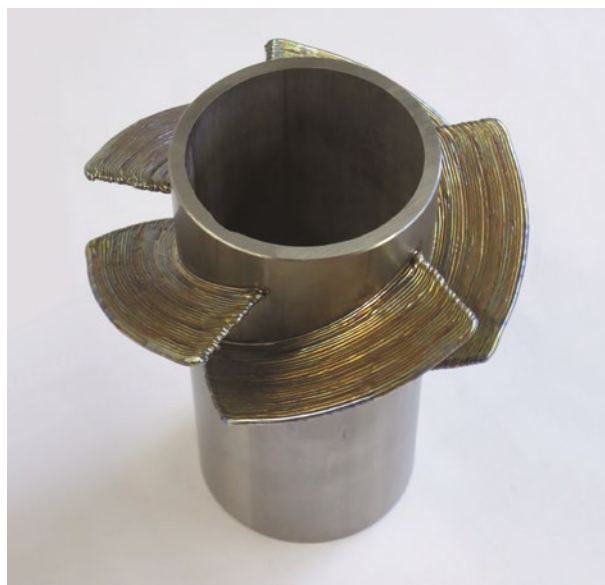
Koaxiális direkt energia felrakás huzaladagolással
