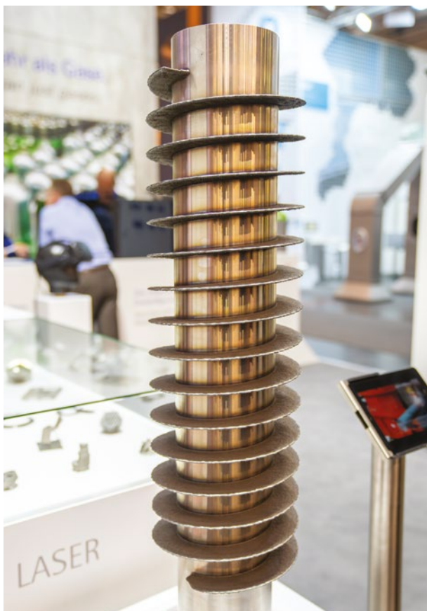
DED-LB eljárással nyomtatott szállítócsiga
